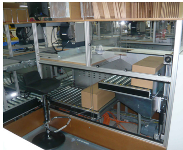
Über einen Lift gelangen die Kartons aus dem Puffer auf die Arbeitsfläche des Bedieners
